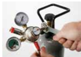
7. Ein- bzw. Nachstellen des Betriebsdrucks (wenn erforderlich)
