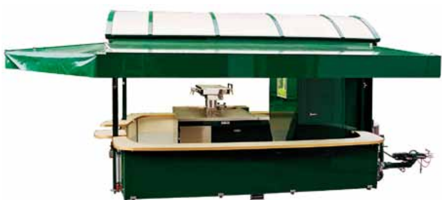
Abb. 19: Ausschankwagen mit begehbarem Kühlraum und integrierter Getränkeschankanlagen
